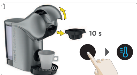
Buka mengunci tangkai. Mesin dihidupkan secara automatik. Sentuh ikon pemilihan suhu dalam masa 10 saat selepas memulakan mesin untuk mengubah ke mod sejuk (biru). Minuman sejuk boleh disediakan dengan sertamerta.
